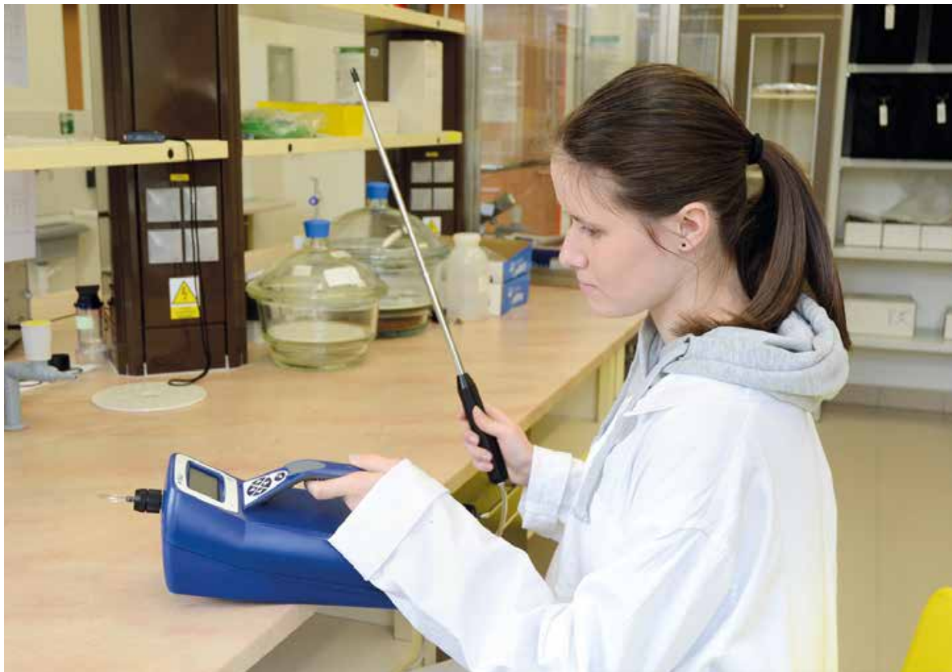
Měření početní koncentrace částic o průměru do 1 \mu\text{m} v pracovním ovzduší laboratoře
