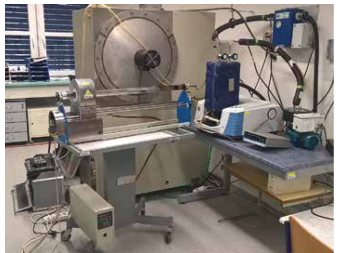
FT-IR spektrometr Nicolet iS10 s příslušenstvím k analýze plyných látek
