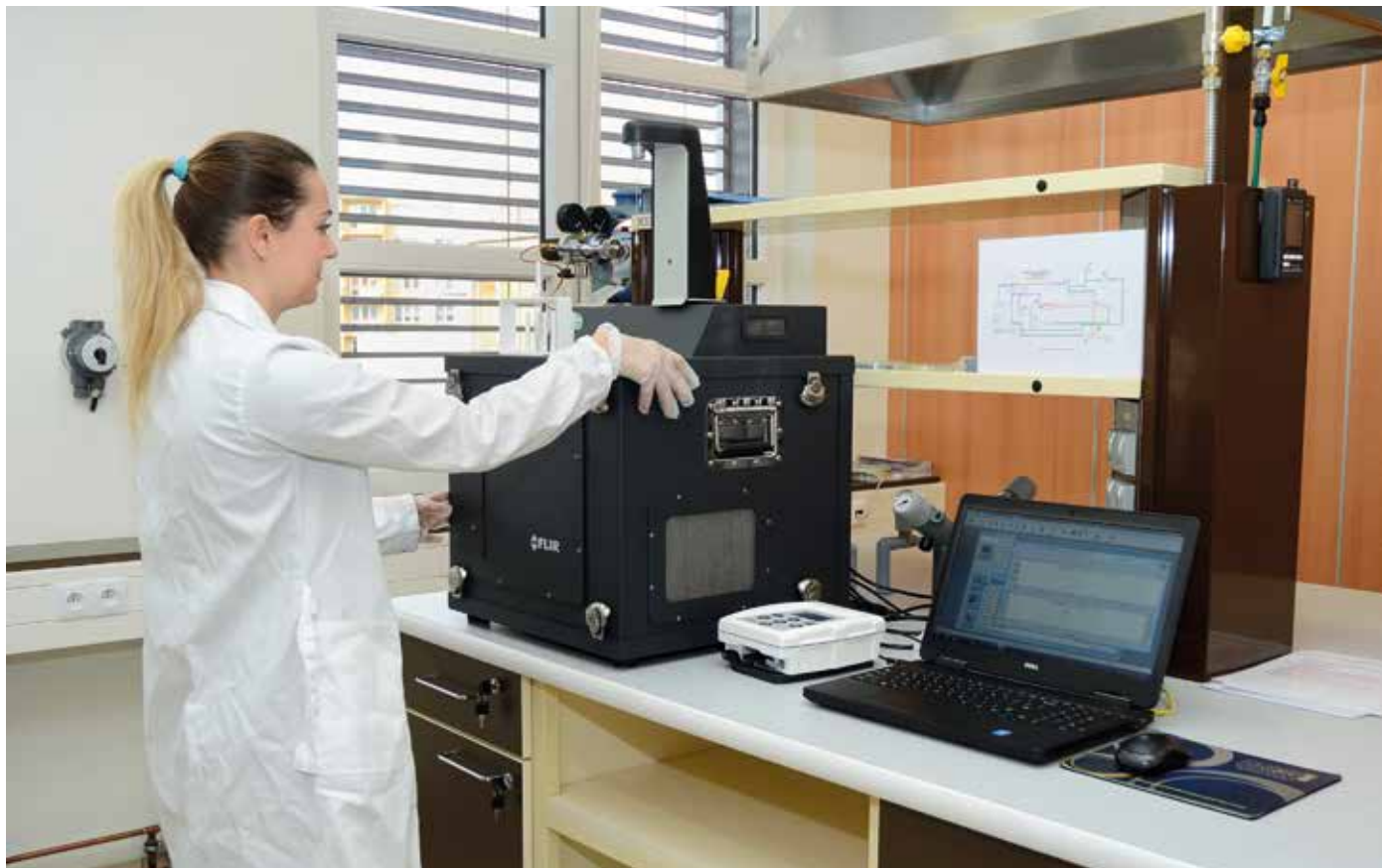
Plynový chromatograf s hmotnostním spektrometrem Griffin 460 s příslušenstvím
