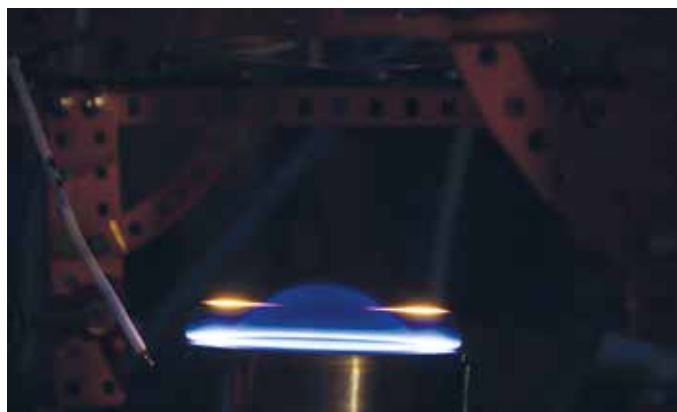
Hartungův hořák při studii režimu nízkoteplotní oxidace dimethyletheru
