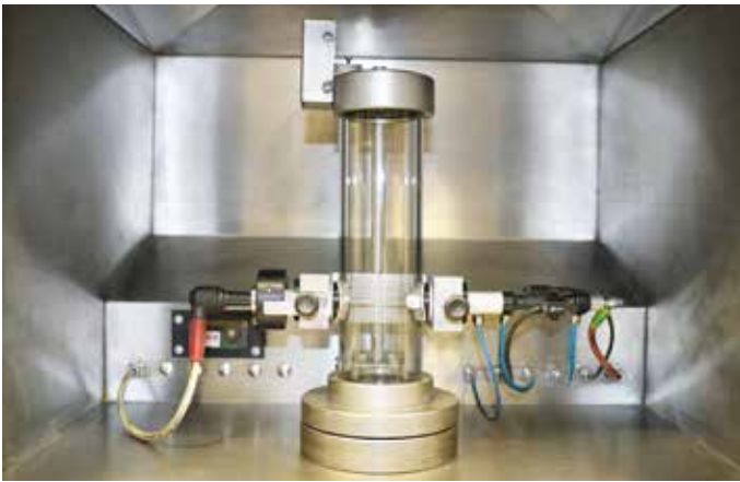
Zařízení pro stanovení minimální iniciační energie prachu MIE D 1.2
