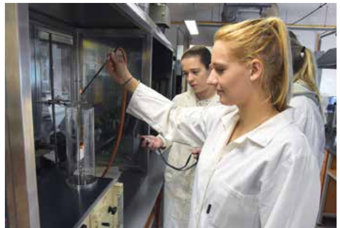
Stanovení hořlavosti metodou kyslíkového čísla
