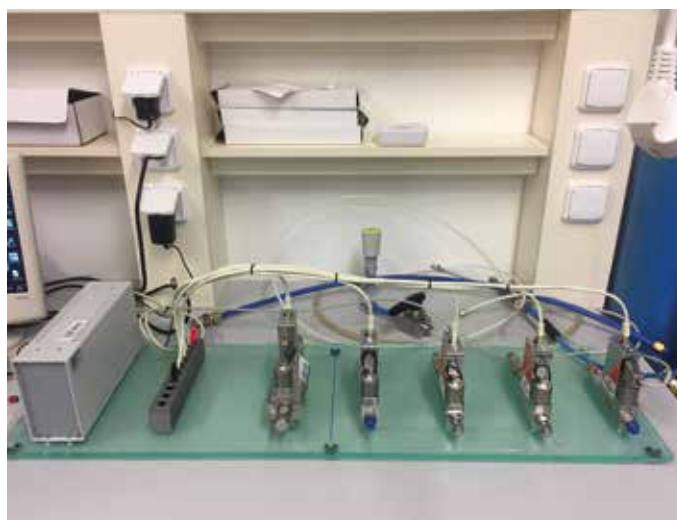
Sestava průtokoměrů pro vytváření definovaných směsí plynů s možností nastavení průtoku v rozmezí 0–1000 l/min, 2 x 0–5 l/min, 0–25 l/min a 0–100 l/min
