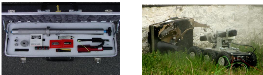
Obrázek 36 - Vodní rozstřelovač na podvozku robota
