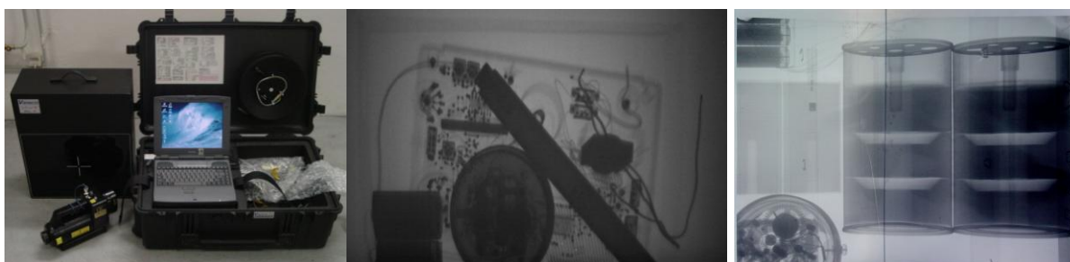
Obrázek 33 - Sestava RTG FOX RAY a snímky podezřelého předmětu
