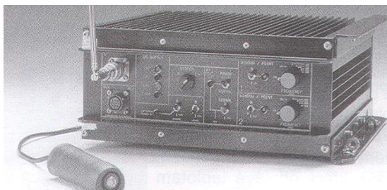
Obrázek 32 - Rušička iniciačního systému NVS
