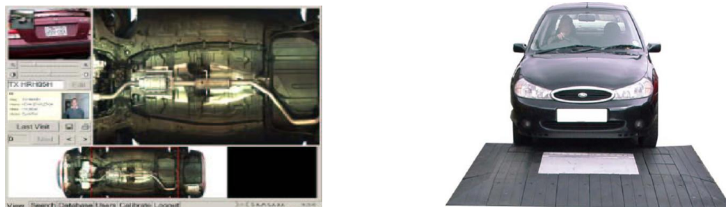
Obrázek 25: Systém kontroly a obrazového výstupu skeneru podvozku
