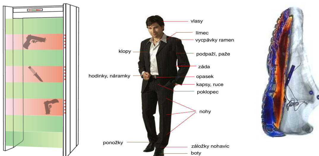
Obrázek15: Znázornění rámového detektoru, fyzická kontrola a ukrytí výbušniny v botě
