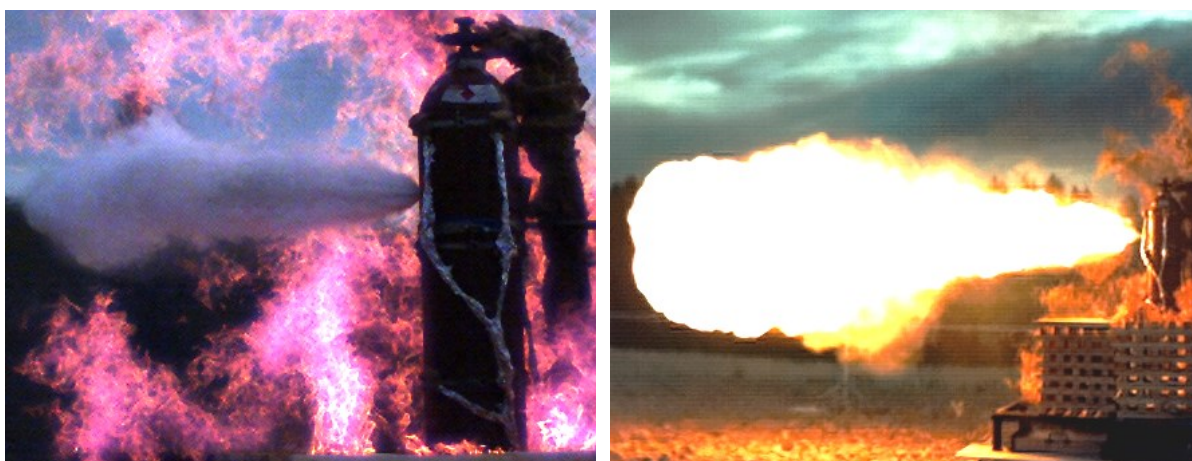
A B Obrázek 12 Prostřelení tlakové lahve a vznik jevu firejet
