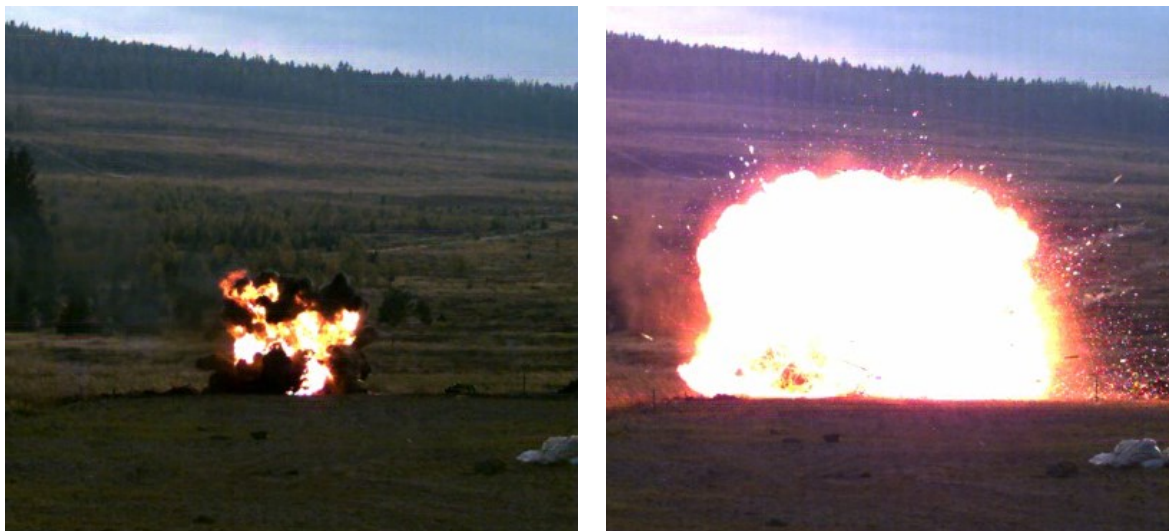
Obrázek 13 Neřízená destrukce lahve a vznik jevu fireball
