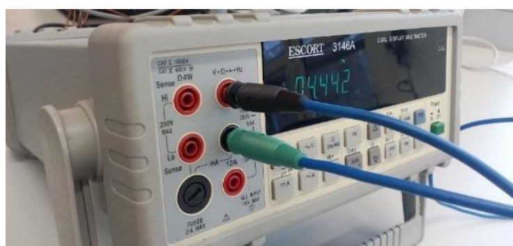
Obrázek 14 Zapojení multimetru pro dvoudrátové měření odporu
