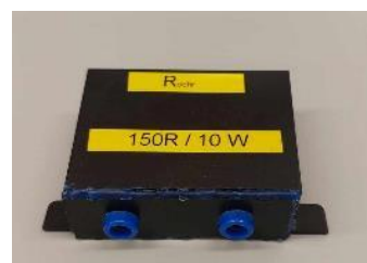
Obrázek 6 Ochranný odpor 150 R/10 W
