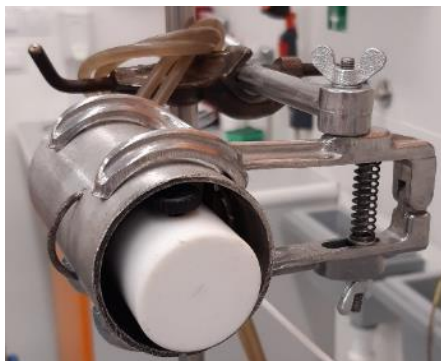
Obrázek 4 Radiometr s bílou krytkou, krytka se musí sundat!!!
