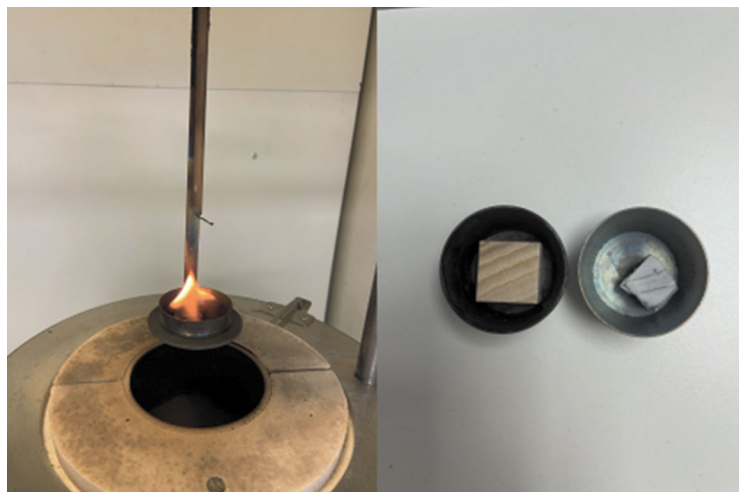
Obrázok 2. Proces horenia vzorky a porovnanie vzorky pred a po meraní
