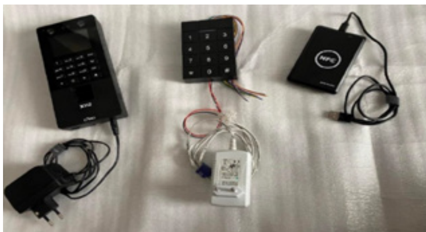
Obrázok 4. Použité RFID čítačky X112 (vľavo), ZONEWAY T11EM (stred) a RFID reader (vpravo) (Zdroj: Vlastné spracovanie)
