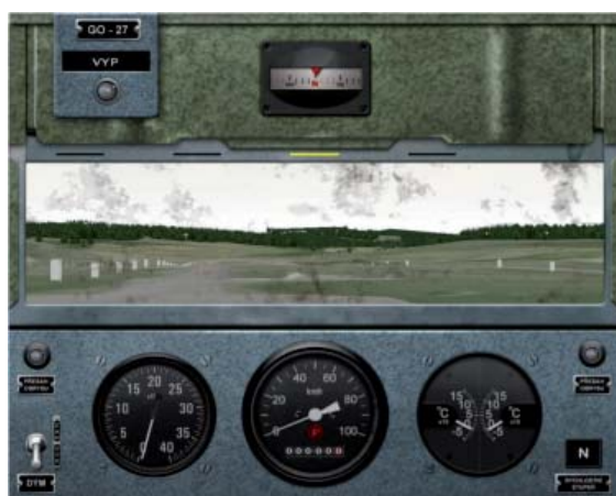
Obr. 2 Rekonfigurovateľný virtuálny simulátor vozidla BVP - 2, výhľad vodiča v bojovej polohe (vľavo) a výhľad veliteľa (vpravo)
