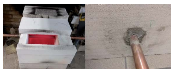
Obr. 7 Měděné potrubí po ukončení zkoušky
