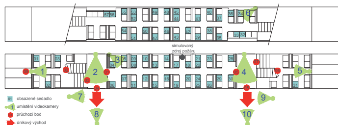
Obr. 2 Schéma evakuačního scénáře A-1-X (rovnoměrné rozmístění osob v horním a dolním oddílu pro cestující, evakuace umožněna dvojicí bočních dveří)
