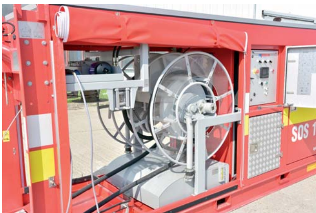
Obr. 2 Nosič kontajnerov MB Arocs s veľkokapacitným čerpadlom (foto: Milan Dermek)
