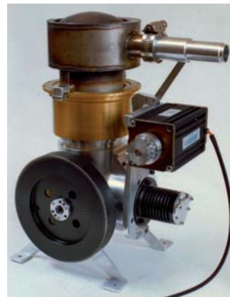
Obr. 2 Stirlingov motor s pracovným označením D-90 (Zdroj: Ross, 2011)
