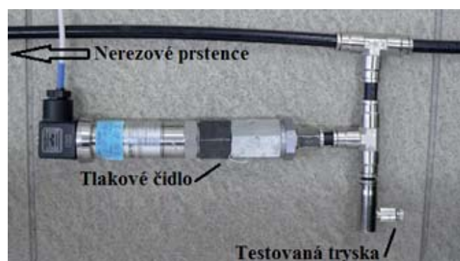
Obr. 3 Měřicí větev na potrubním systému
