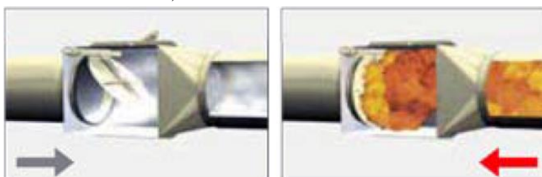
Obrázek č. 49 – Princip funkce zpětné klapky
