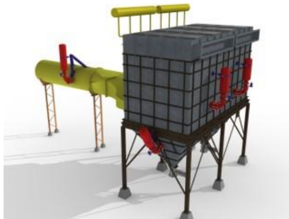
Obrázek č. 43 - Návrh HRD zařízení na potlačení exploze na filtrační jednotce na odsávání uhlénoho prachu
