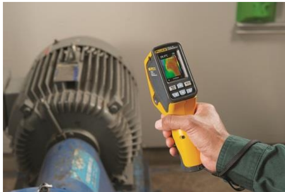
Obrázek č. 29 – Monitorování teploty motoru pomocí termovize
