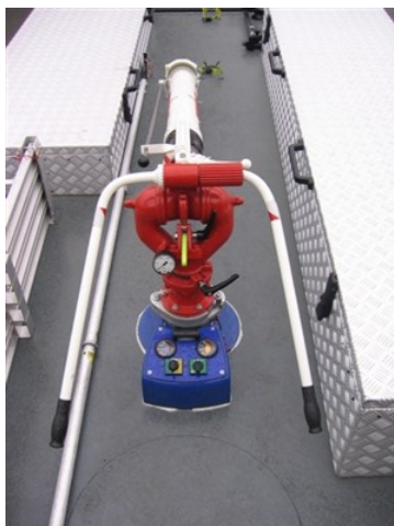
Obr. 3.38 Zabudovaná lafetová proudnice na střeše CAS
