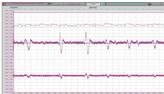
Obr. 6 Záznam z Hallovy sondy (horní část grafu) i cívkových sond (úzká cívka - střední křivka, široká cívka - dolní křivka) v případě simulace statického měření
