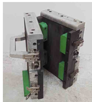
Obr. 3 Defektoskop na plochá ocelová lana INW-PO01
