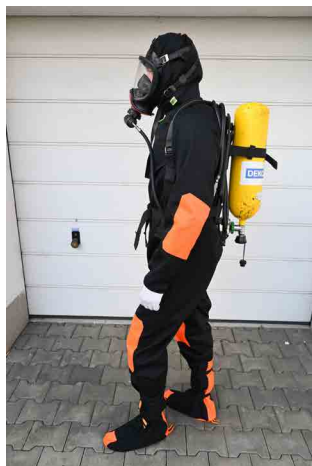
Obr. 6 Navržený podvlek DEKONTEX z adsorpční uhlíkové textilie Flexzorb FM30K D151 s dýchacím přístrojem
