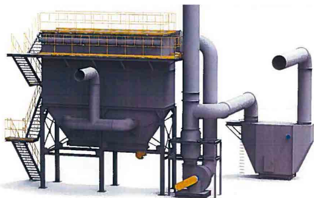
Obr. 1 Tkaninový filtr s HEPA filtrem [autor]
