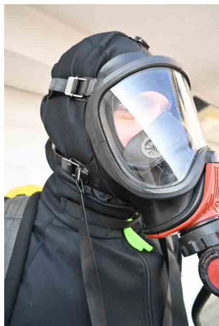
Obr. 6 Navržený podvlek DEKONTEX z adsorpční uhlíkové textilie Flexzorb FM30K D151 s dýchacím přístrojem
