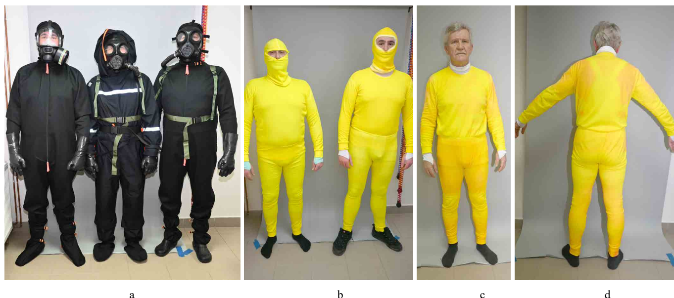
Obr. 5 a - testované oděvy NANOTEX (uprostřed) a DEKONTEX (po stranách); b - zabarvení indikačního prádla pod oděvy DEKONTEX po testu v toxikologické komoře s atmosférou chlóru; c, d - zabarvení indikačního prádla pod oděvem NANOTEX po testu v toxikologické komoře s atmosférou chlóru
