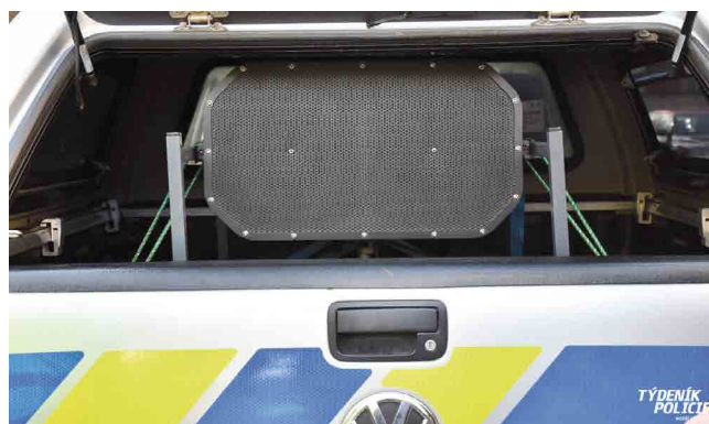
Obr. 2-3 Způsob umístění systému LRAD ve služebních vozzech Policie ČR. Foto Týdeník policie
