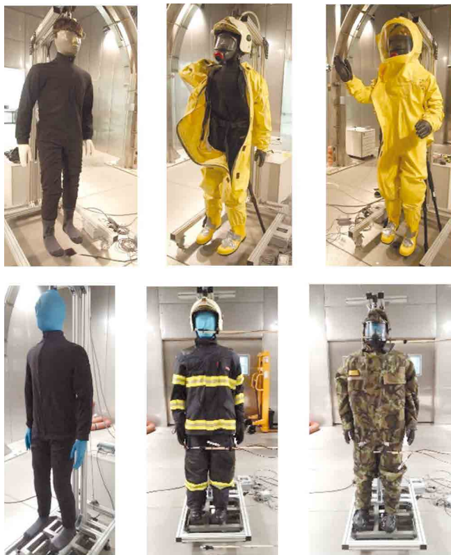
Obr. 2 Ukázky z měření tepelně-izolačních vlastností oděvů pomocí 34-zónového tepelného manekýna Newton
