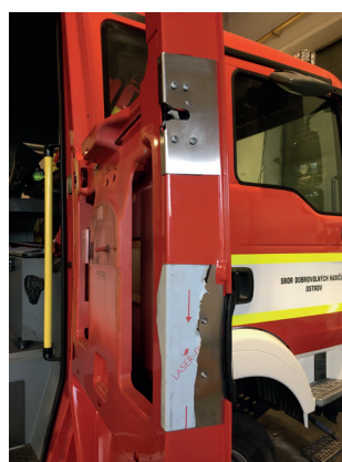
Obr. 4 Dveře pro mužstvo po opravě
