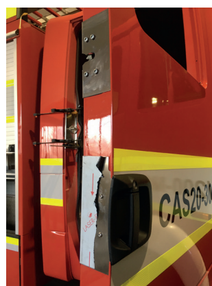
Obr. 4 Dveře pro mužstvo po opravě
