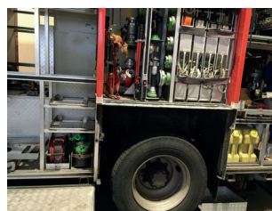
Obr. 10 Výroba nových blatníků z hliníkového plechu
