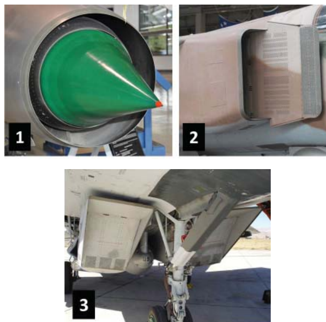
Obr. 2 Příklady vstupních ústrojí pro sání vzduchu do kompresoru proudového motoru: (1) MiG-21MF, (2) MiG-23BN, (3) MiG-29A [6]
