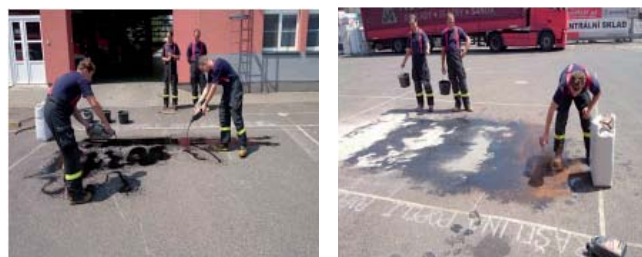
Obr. 1-2 Aplikace testovaných popelů a rašeliny na ropné produkty
