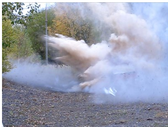
Obrázek č. A13a A 14: Detonační proces vodní kumulativní nálože v čase 0,040 a 0,045sekundy
