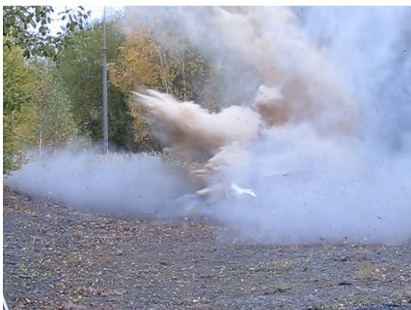
Obrázek č. A11 a A12: Detonační proces vodní kumulativní nálože v čase 0,030 a 0,035 sekundy
