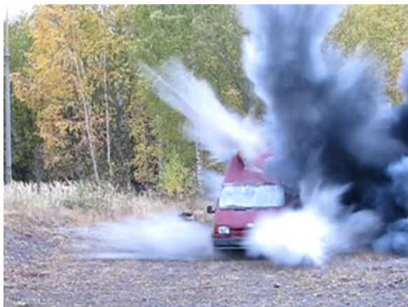
Obrázek č. A7a A8: Detonační proces vodní kumulativní nálože v čase 0,010 a 0,015 sekundy
