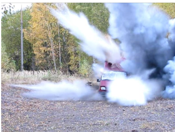
Obrázek č. A9 a A10: Detonační proces vodní kumulativní nálože v čase 0,020 a 0,025 sekundy
