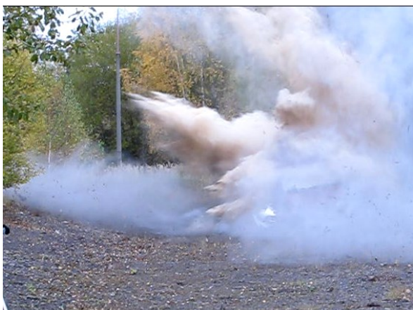
Obrázek č. A13a A 14: Detonační proces vodní kumulativní nálože v čase 0,040 a 0,045sekundy
