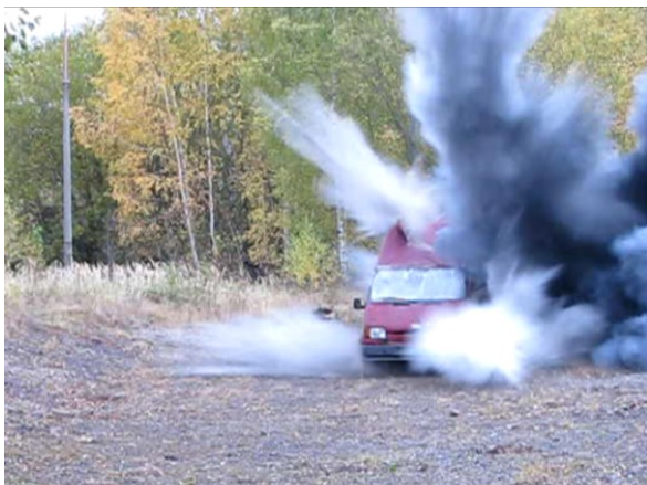
Obrázek č. A7a A8: Detonační proces vodní kumulativní nálože v čase 0,010 a 0,015 sekundy
