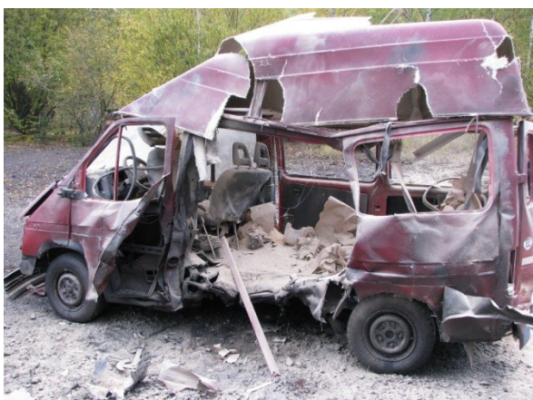
Obrázek č. A17: Výsledný efekt vodní kumulativní nálože na VTN (vlevo)
