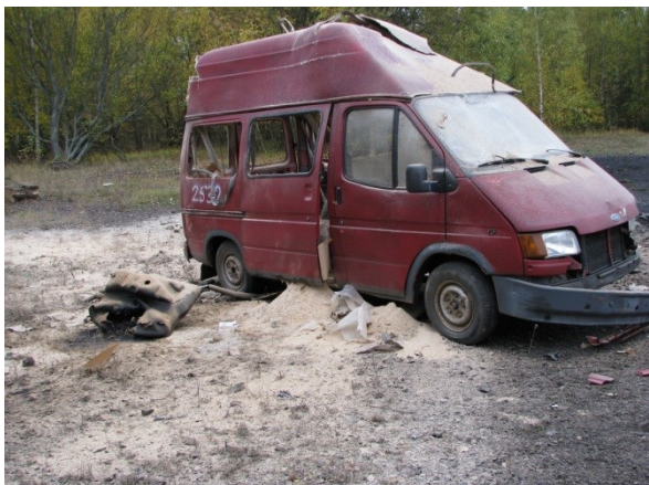
Obrázek č. A19: Rozhození použité trhaviny typu DAP mimo zneužitě vozidlo (vlevo)
