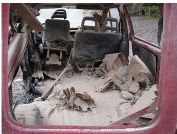
Obrázek č. A17: Výsledný efekt vodní kumulativní nálože na VTN (vlevo)
