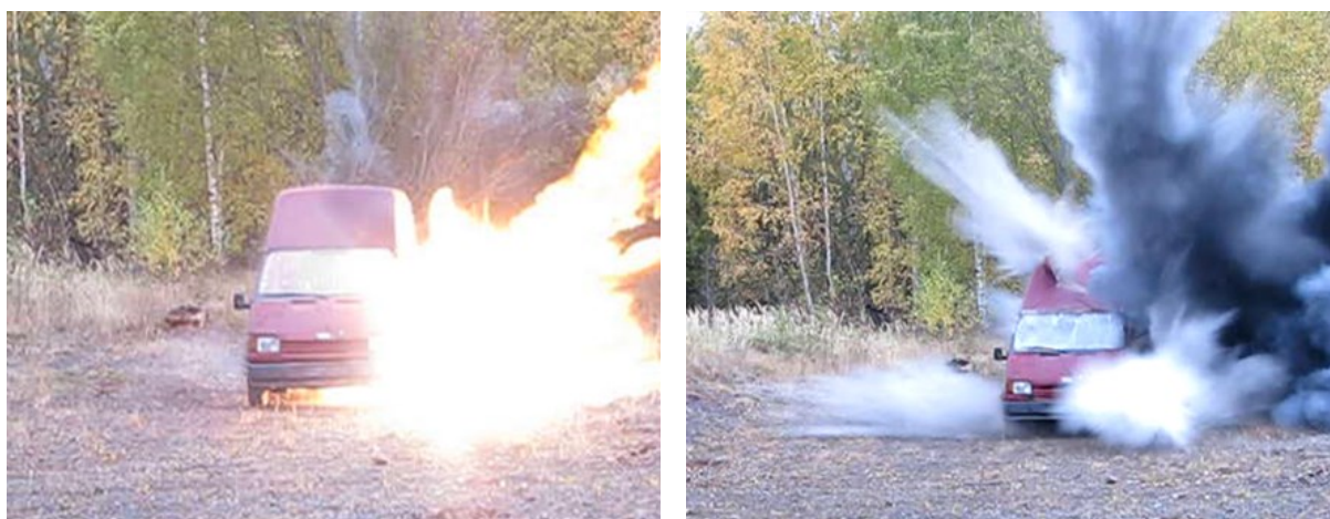
Obrázek č. 3 a 4: Viditelný ohnivý projev výbuchové teploty v reálném čase 0,005 sekundy od iniciace a jeho zjevné potlačení v reálném čase 0,010 sekundy od iniciace
