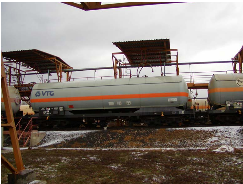
Foto č. 4: Pohled na železniční cisternu pro přepravu amoniaku na pozici stáčení
