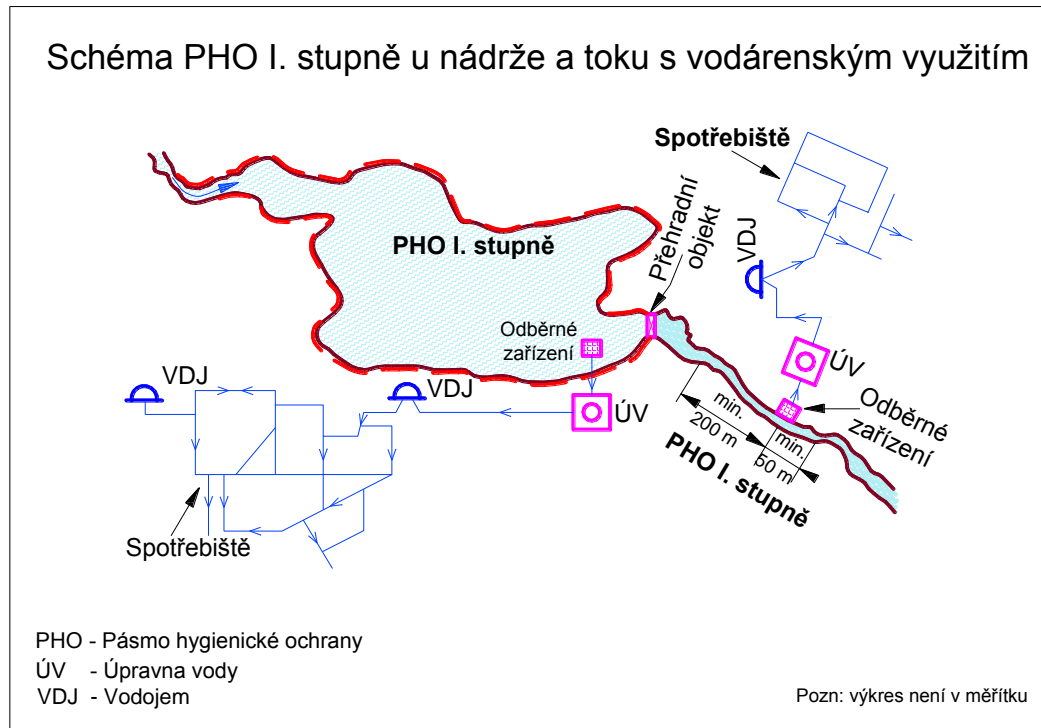
Obr. 5.1 Schéma ochranného pásma I. stupně u nádrže a toku s vodárenským využitím
