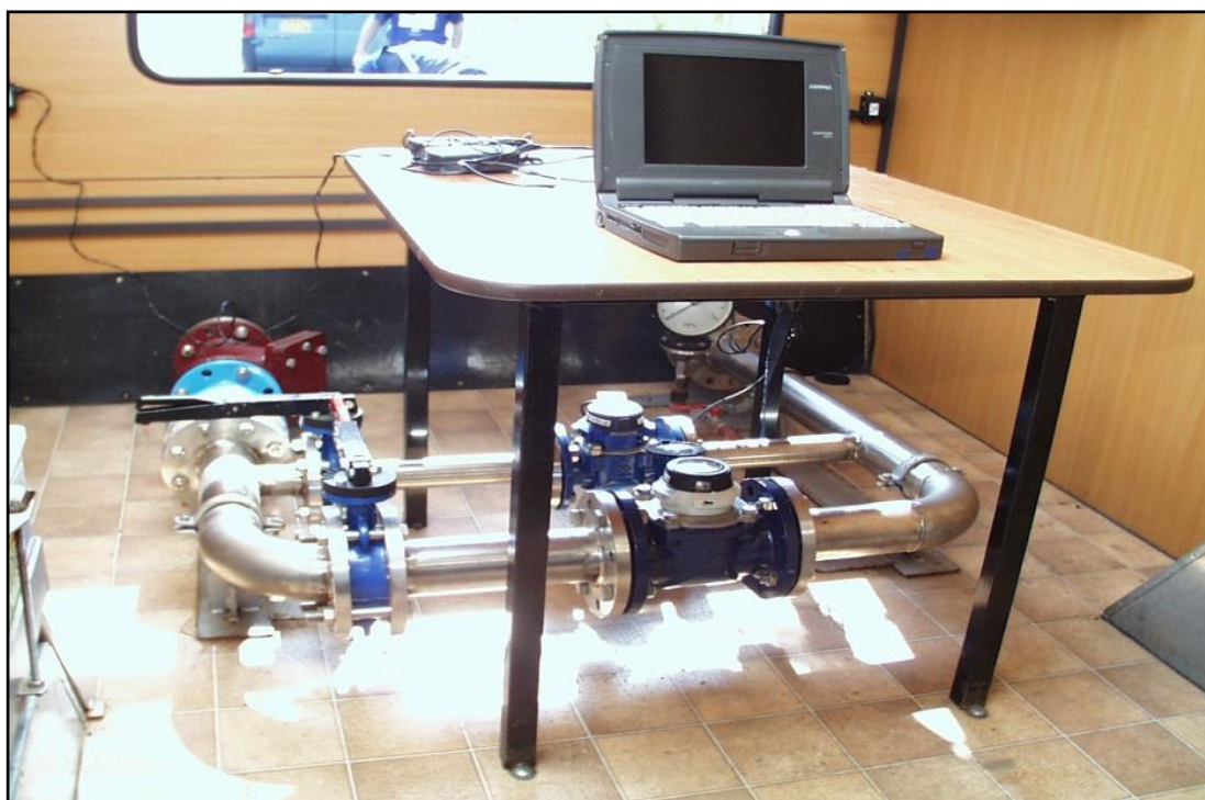
Obr. 5.21 Zařízení pro mobilní měření objemových a průtokových veličin
