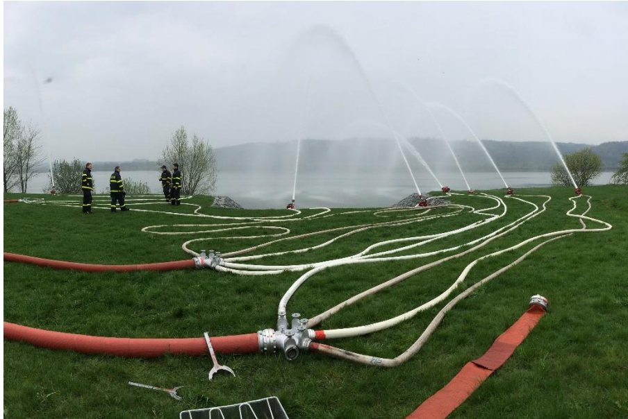
Obrázek 21 Pro dopravu velkého množství vody na velké vzdálenosti se používají hadice nadstandardních průměrů (152 mm, 254 mm)
