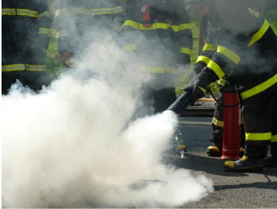
Obrázek 32 Suchý led generovaný přenosným hasicím přístrojem \text{CO}_2
