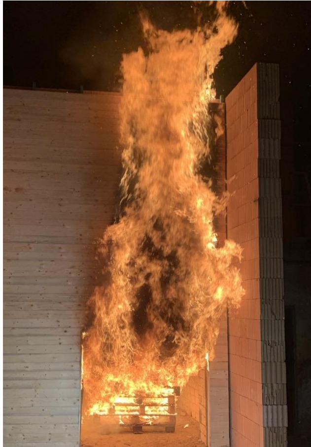
Obrázek 2 Odhořívání dřevěných palet a palubkového obložení stěny při velkorozměrové zkoušce
