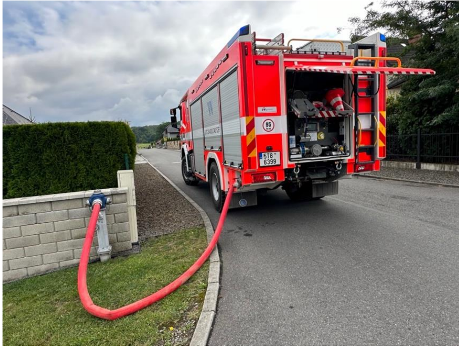
Obrázek 23 Plnění cisternové automobilové stříkačky z nadzemního hydrantu
