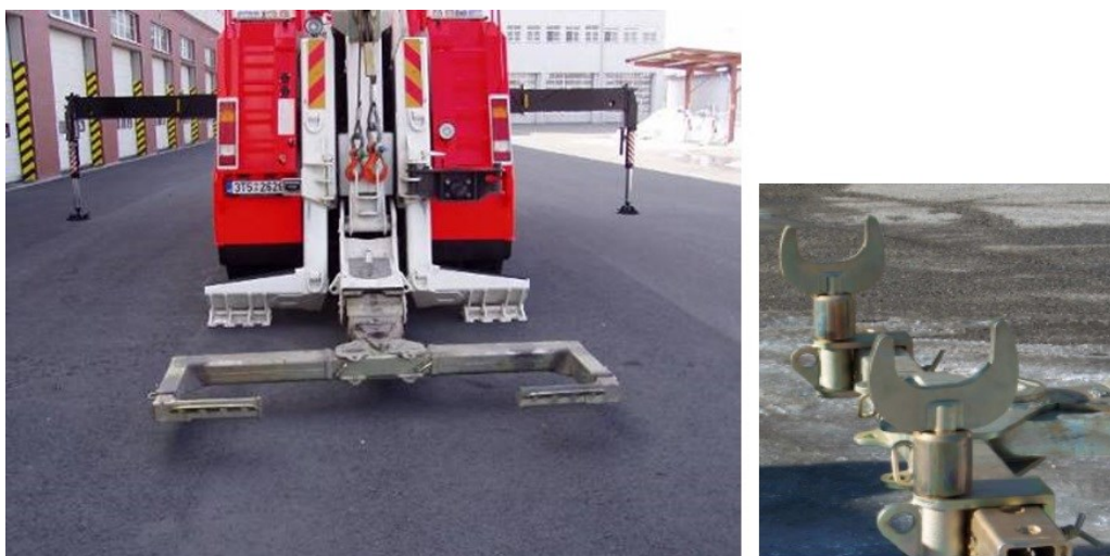
Obrázek 7.4 Vysouvací rameno a nástavec s vidlicemi pro vyprošťování [2]
