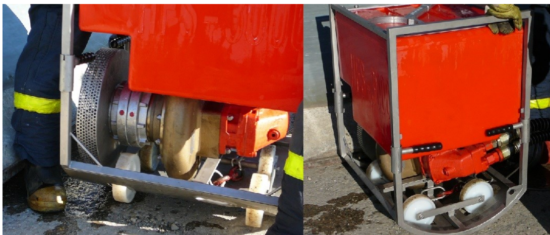
Obrázek 6.9 Detail a celkové foto ponorného čerpadla
