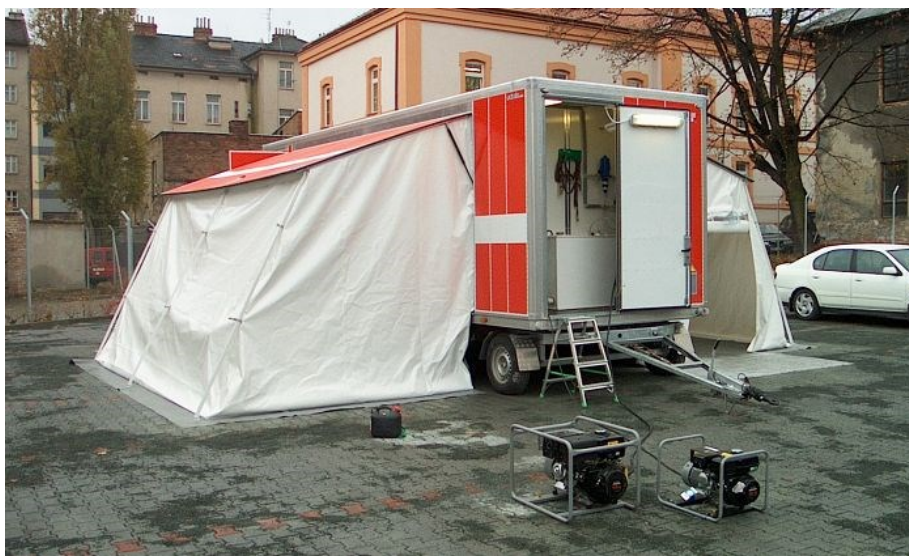
Obrázek 4.2 Stanoviště dekontaminace osob SDO-2
