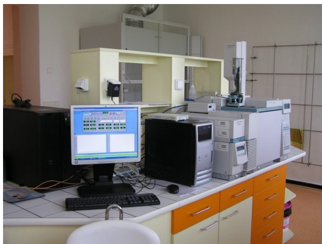
Obrázek 3.10 Chemicko-toxikologické pracoviště (GC-MS systém Agilent Technologies)
