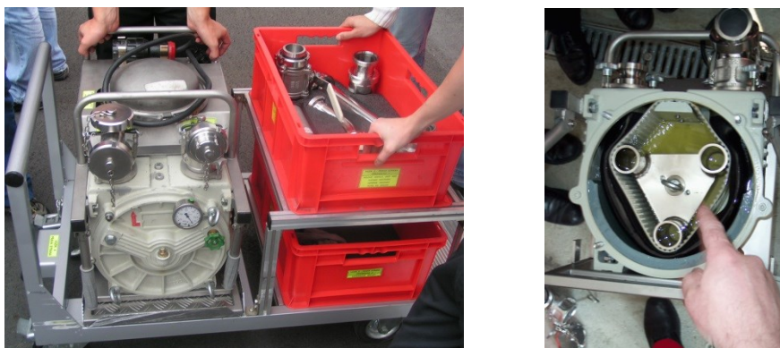
Obrázek 2.3 Hadicové čerpadlo s příslušenstvím detailem rotorové skříně
