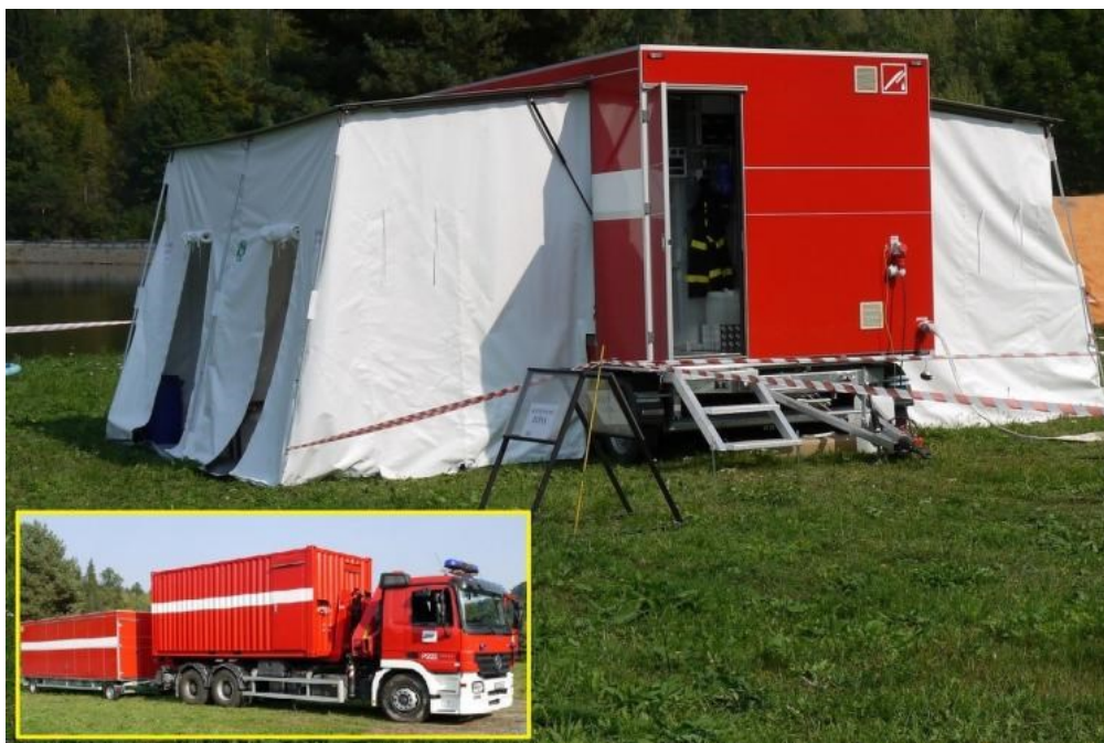
Obrázek 4.11 Stanoviště dekontaminace osob SDO-3 [2, 4]
