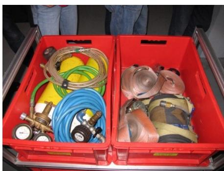
Obrázek 2.11 Pásové ucpávky potrubí s příslušenstvím a jejich aplikace
