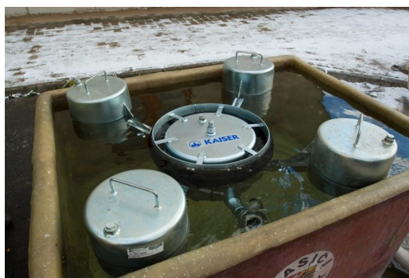
Obrázek 8.5 Hladinový sběrač Kaiser
