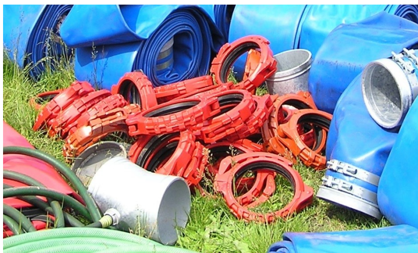
Obrázek 5.16 Hadice s kovovými přírubami a spojky Snaps Joins
