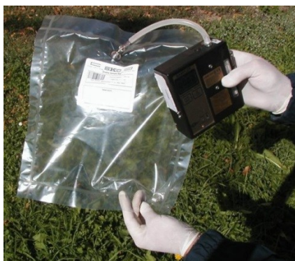
Obrázek 3.5 Odběr vzorků vzduchu do vzorkovacího vaku pomocí plynového odběrového čerpadla PCXR4 [7]
