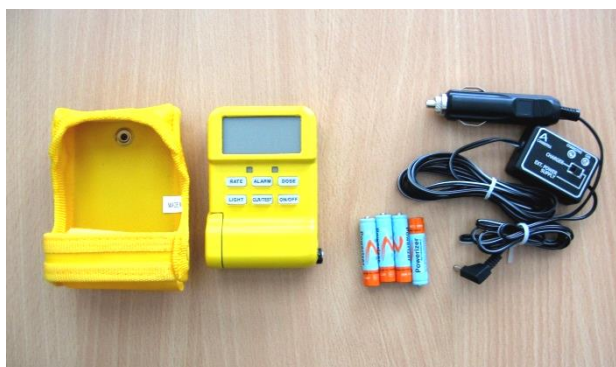
Obr. 25 Zásahový dozimetr UltraRadiac URAD 115
