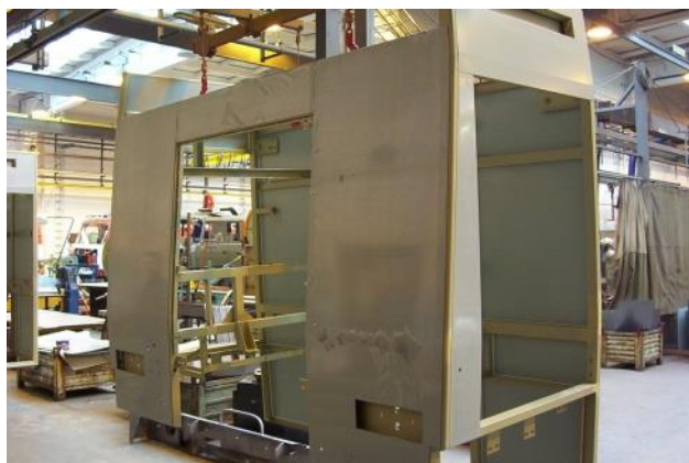
Obr. 8 Výroba ocelové konstrukce zadní části nástavby CAS
