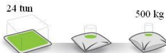
Obr. 18 Princip vysokotlakých vaků [3]
