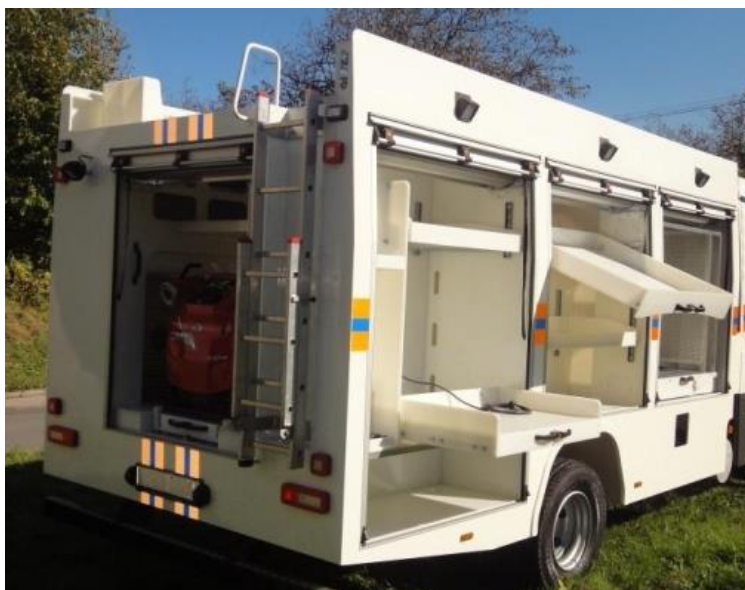
Obr. 11 Nástavba vyrobená z Polyprenu bez povrchové úpravy [8]
