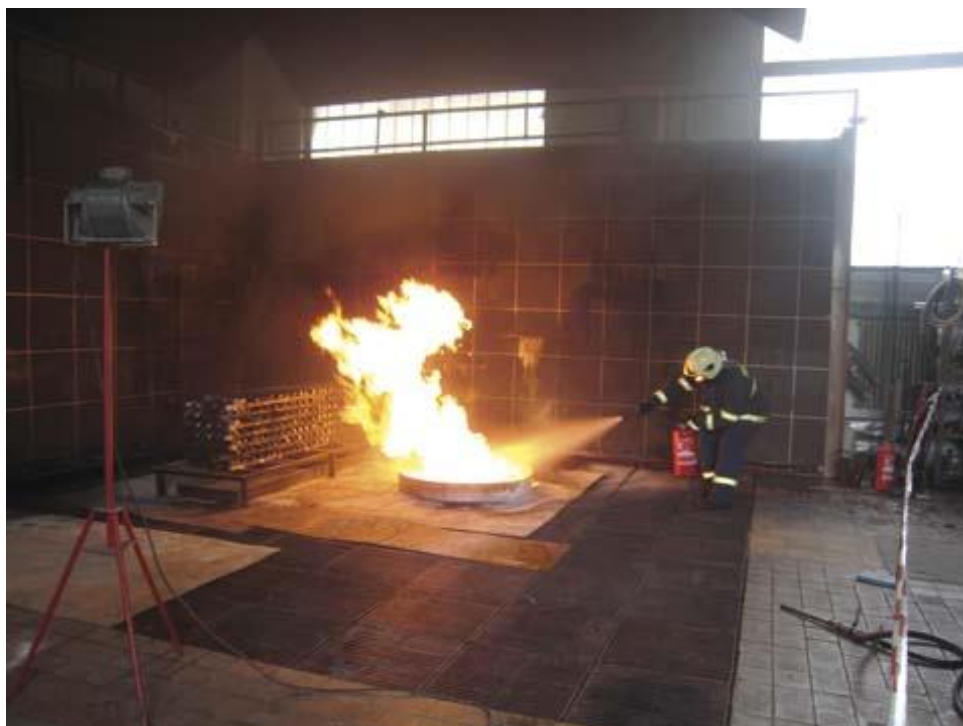
Obr. 6 Ukázka hašení zkušebního objektu na třídu požáru B [5]
