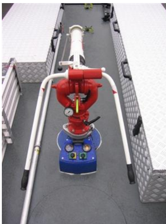
Obr. 38 Zabudovaná lafetová proudnice na střeše CAS
