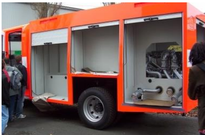
Obr. 10 Nástavba vyrobená z polyesteru včetně povrchové úpravy
