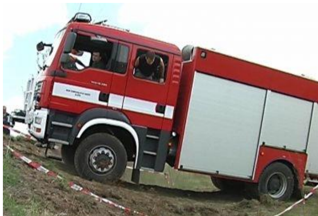
Obr. 25 Kontrola předního a zadního nájezdového úhlu
