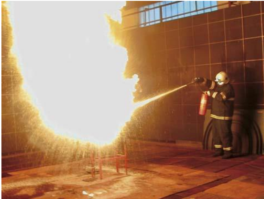
Obr. 9 Ukázka hašení zkušebního objektu na třídu požáru B [5]
