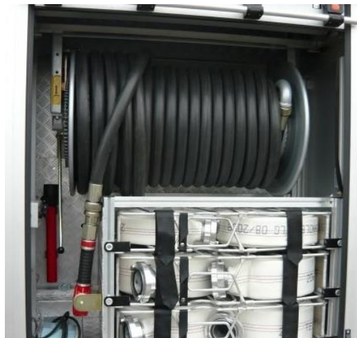
Obr. 12 Průtokový naviják s hadicí a připojenou vysokotlakou proudnicí
