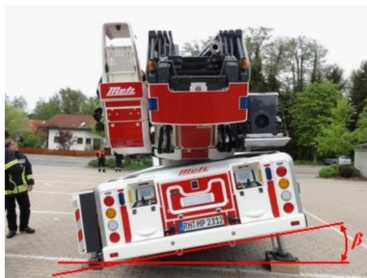
Obr. 6 Příčný náklon automobilového žebříku [4]
