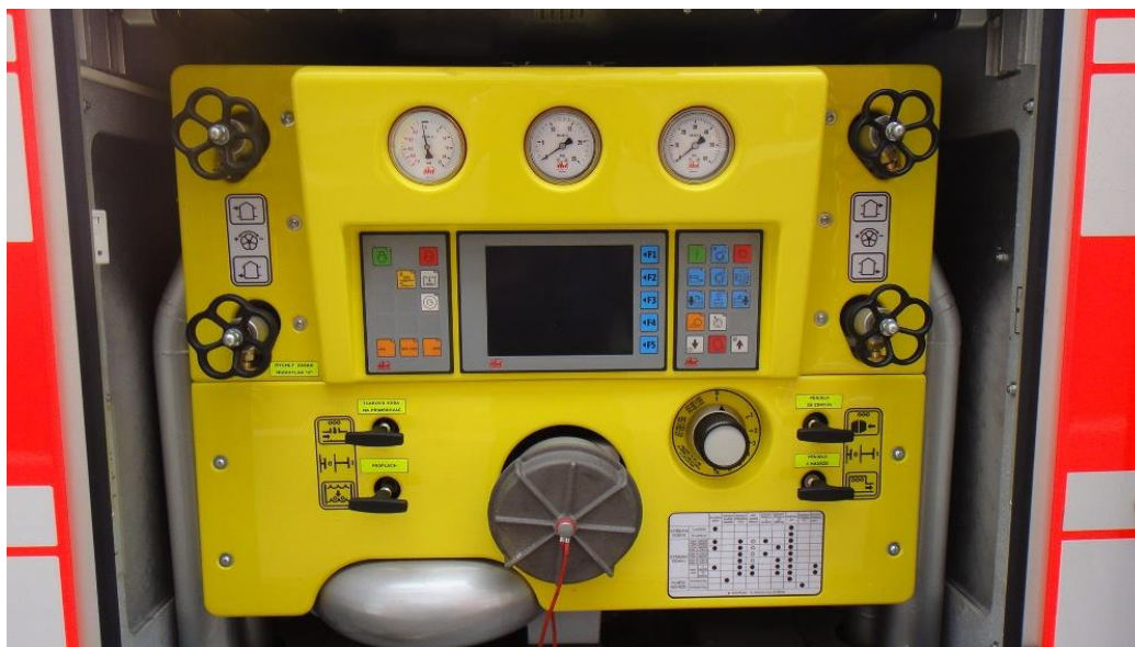
Obr. 18 Obslužné místo čerpacího zařízení moderního provedení [9]
