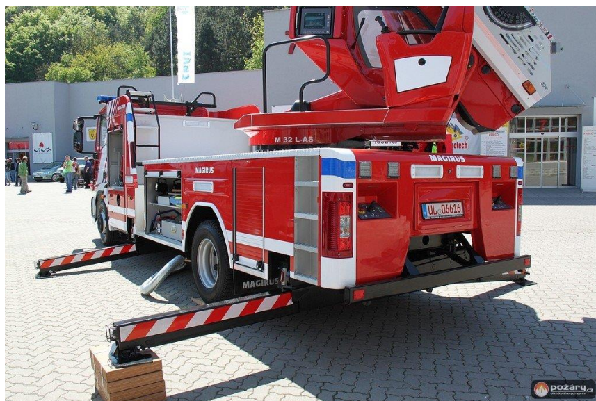
Obr. 23 Ustavení automobilového žebříku Iveco Magirus M 32 L-AS [4]
