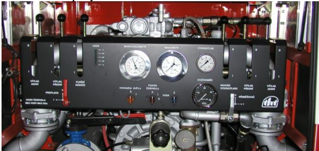
Obr. 17 Obslužné místo čerpacího zařízení klasického provedení
