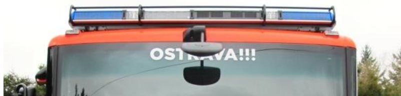
Obr. 5 Výstražné světelné zařízení na čele kabiny [7]
