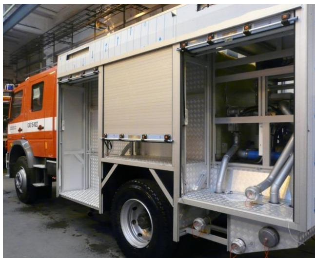
Obr. 9 Hliníková konstrukce nástavby
