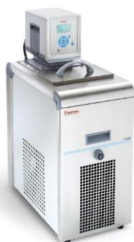
Obrázek 4 Termostat pro zahřívání vodní lázně
