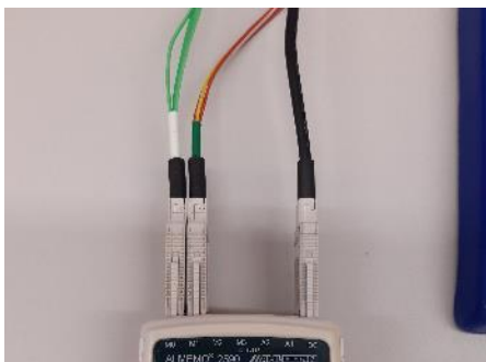
Obrázek 8 Připojení konektorů k dataloggeru ALMEMO
