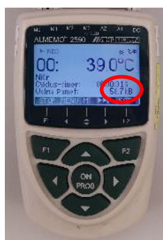
Obrázek 10 Datalogger plný dat, paměť se s množstvím dat zmenšuje
