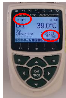
Obrázek 9 Zapnutí nahrávání dat na dataloggeru ALMEMO
