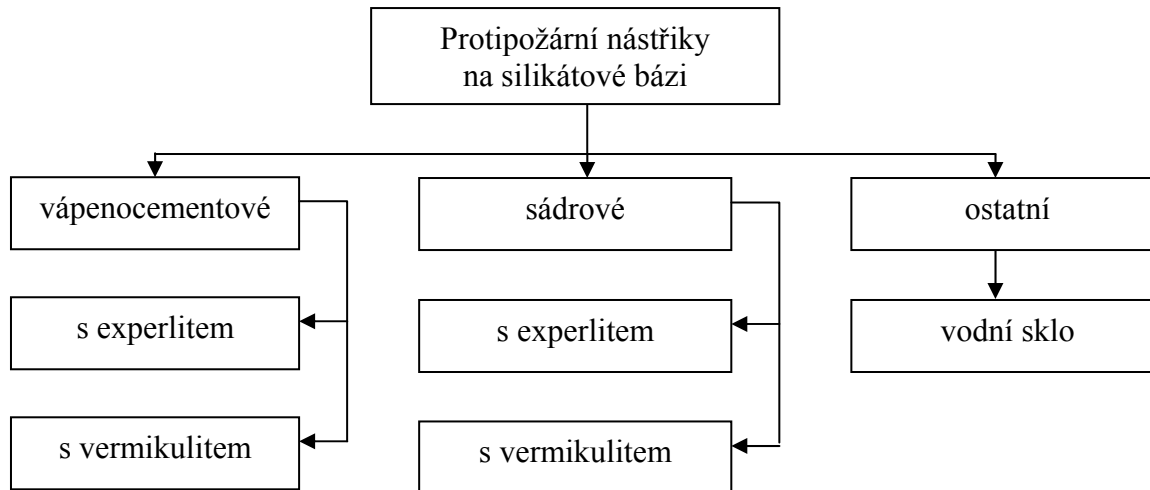
Obr. 8.2 Protipožární nástřikové hmoty na silikátové bázi
